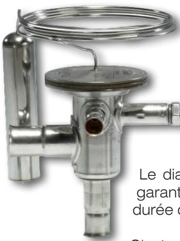
Cette vanne fonctionne comme **régulateur de puissance** pour adapter l'énergie développée par le compresseur frigorifique au taux de charge réel de l'évaporateur afin de maintenir dans ce dernier une température d'évaporation légèrement supérieure à 0°C.
