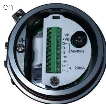
Bornier à vis, avec identification des signaux, situé à l'intérieur du boîtier de raccordement.
