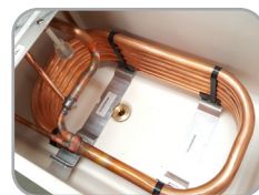
Échangeur tubulaire
