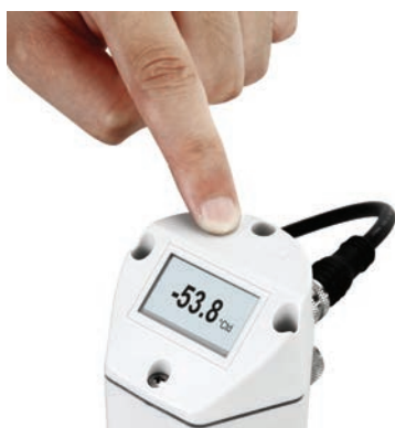
Réglage de l'alarme sur le l'hygromètre au moyen des touches sensibles.
